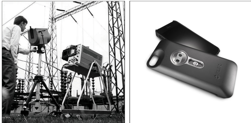
Figura 14.2 SINISTRA: Thermovision Modello 661 del 1969. La termocamera pesa circa 25 kg, l'oscilloscopio 20 kg e lo stativo 15 kg. L'operatore inoltre doveva procurarsi un generatore elettrico da 220 VCA ed un contenitore da 10 litri con azoto liquido. Alla sinistra dell'oscilloscopio è visibile l'attacco Polaroid (6 kg). DESTRA: FLIR One, lanciato nel gennaio 2014, è un accessorio scorrevole che offre ai dispositivi iPhones funzionalità di creazione di immagini termiche. Peso: 90 g.
